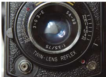
【4A-105】シャッターロックがなく、レンズ部にトリプレットの「3-G 3-E」表記
