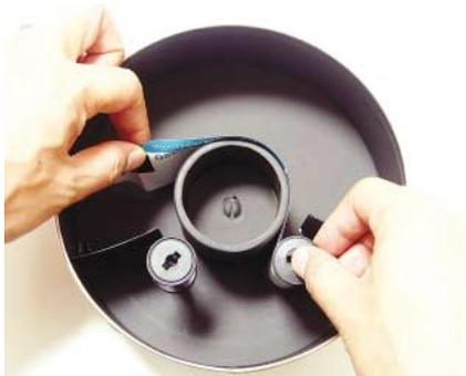
写真4 プロネフィルムの装填
