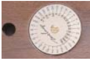
背面の露光ガイドにセットし、F138の位置の数値を読み取れば必要な露光時間を簡単に知ることが出来る。2秒以上の長時間露光時は相反則不軌により露光時間を2倍~12倍にする必要があるが、その目安も説明書に記載されているので安心。左の穴はブローニー用のフィルムカウンター窓
