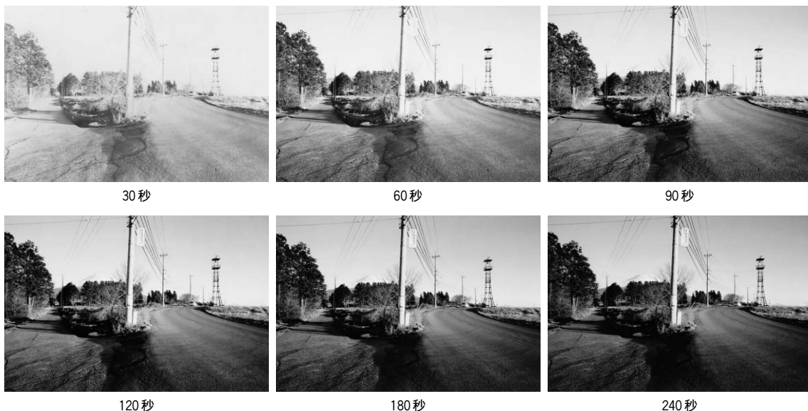
写真1 現像の進み方。20、テクトール・ニュートラルとベルゲール・バリアブルNB、2号。 この現像液は液色が黄色である。現像開始後20秒経過したところで画像が現れる。60秒を過ぎるとしだいに画像が整っていく。 90秒を過ぎて120秒に至り、良好な画像となる。その後、現像が徐々に進み、240秒まで現像したが、問題はなかった。 この組合せによる現像では、現像時間が長いほうで、すばらしい再現のプリントが作れる
