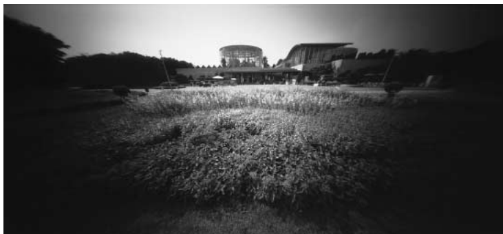
25mmのピンホールで撮影。周辺部の光量が極端に落ちている。シャッター速度約1秒
