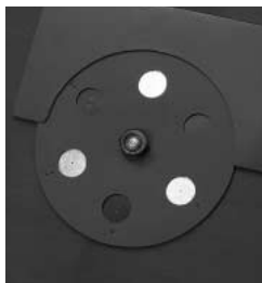
ボディの裏側に、ピンホールとゾーンプレートを3つずつ取り付けられたターレットを備えている
